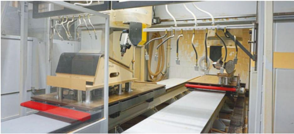
*/ Die neue Maka-CNC hat viel zu bieten: Unter anderem die parallele Bearbeitung zweier Bauteile unabhängig voneinander sowie zwei 5-Achs-Aggregate HSK F63 angebunden an einer Steuerung.*
