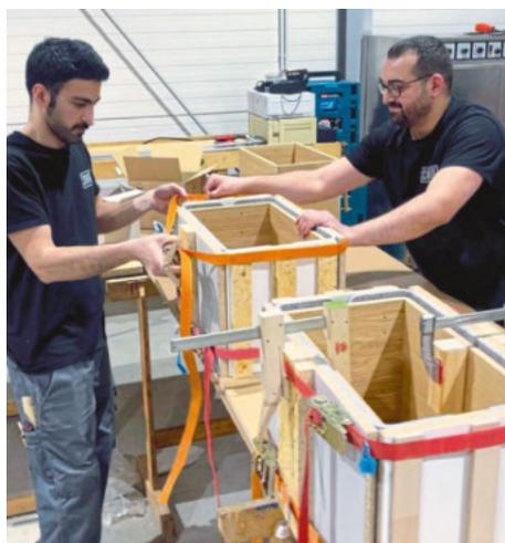
*/ Mit gleichmäßigem Druck wurde das zuvor in Form gebrachte Vlies auf den Eichenkorpus geklebt.*
