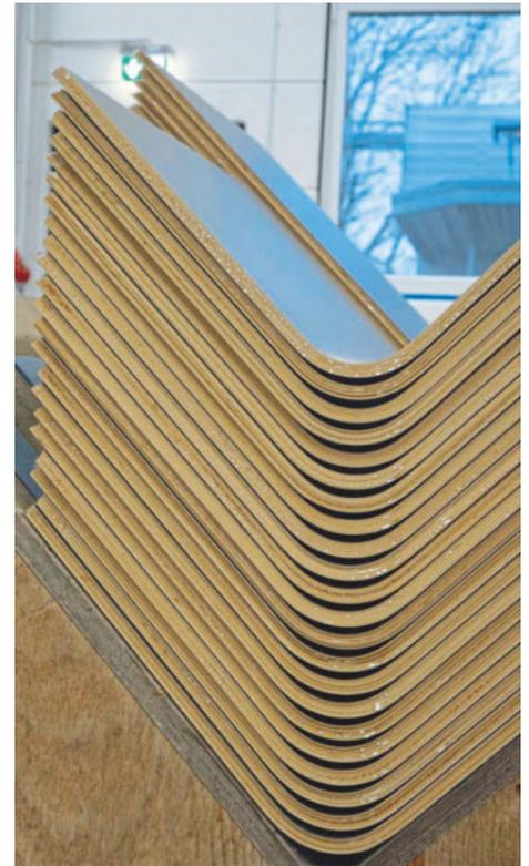
/ Gepresst, gefräst, nachgearbeitet und kaschiert. Ein Bauteil durchläuft diverse Stationen in der Produktion.
