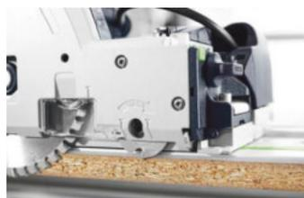
/ Die integrierte Vorritzer-Einheit ermöglicht beidseitig ausrissfreie Schnitte.
