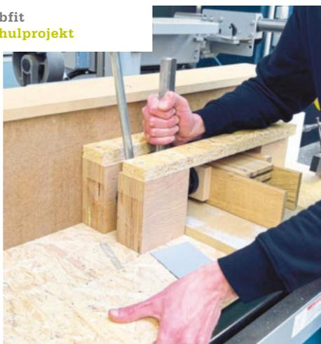
*/ Effizient gezinkt: Bei der Produktion kamen zahlreiche selbst entwickelte Vorrichtungen zum Einsatz.*
