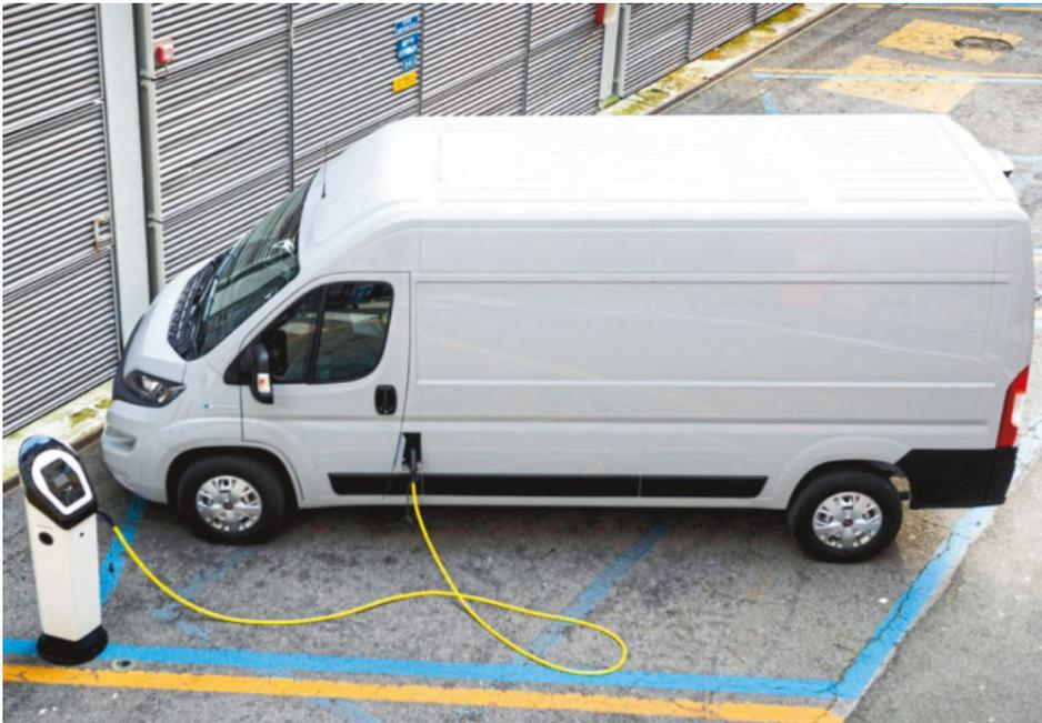
/ Hier an der Säule Typ 2: Für den Antrieb mit 90 kW/122 PS gibt es Akkus mit 47 oder 79 kWh.
