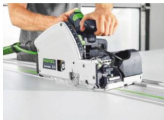
/ Das Diamant-Vorritz-Sägeblatt kann flexibel ein- oder ausgeschaltet werden.
