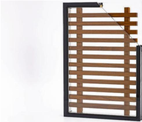
/ Die filigranen horizontalen Holzstäbe mit einer Ansichtsbreite von 10 mm werden in Abständen von 50 bis 60 cm durch ebenfalls 10 mm breite Setzhölzer getragen.
