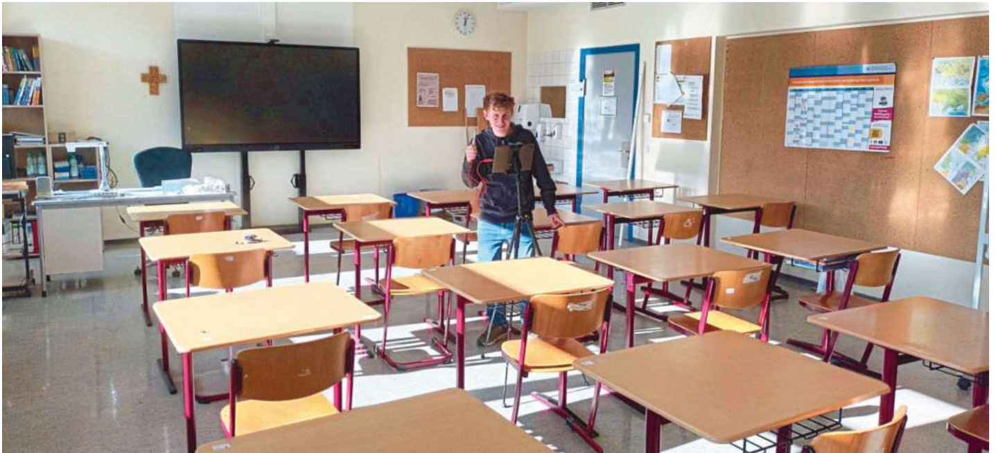
! Messung der Nachhallzeit in einem Klassenzimmer nach DIN EN 3382-2 (Standardverfahren), durchgeführt von Lennox Lehner mit dem Raumakustik-Planer (RAP).
