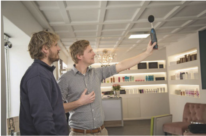
/ Schallmessung in der Praxis: Michael Fuchs (r.) und Simon Holzer bei raumakustischen Messungen in einem Objekt (Friseursalon Max in Wallersdorf).
